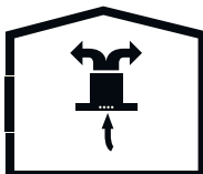
sl. 4: Kroženje zraka preko ogljenih filtrov
